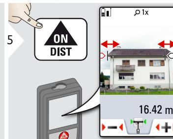
Zvolte směrové šipky pomocí kurzorových tlačítek nebo klepnutím na obrazovku a upravte pomocí funkčních tlačítek. Dojde k výpočtu odpovídající šířky.
