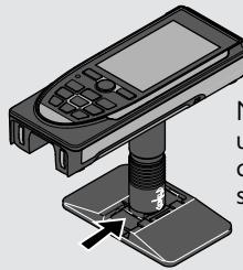
Nástavec chytrého stojanu umožňuje provést stabilní cílení bez neúmyslného sklopení zařízení.
