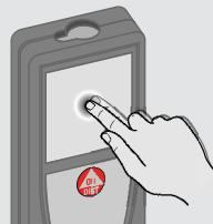
Výběr nebo otevření položky na obrazovce provedete klepnutím. Klepnutím na ikonu uprostřed spodního rádku aktivujete měření vzdálenosti nebo zapnete fotoaparát.
